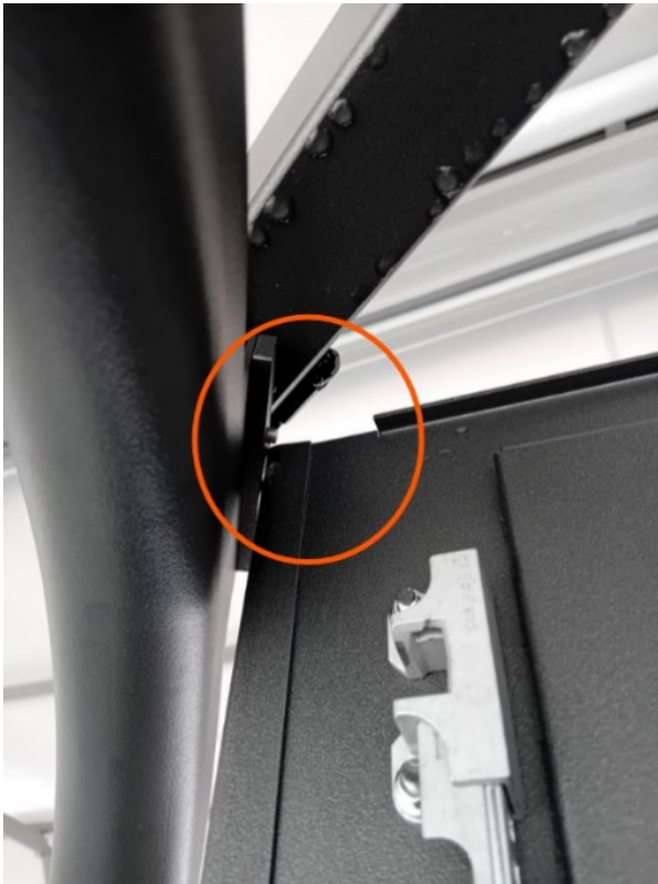
Abbildung 19: Empfindlicher Eckbereich – Dispenser-Tür
